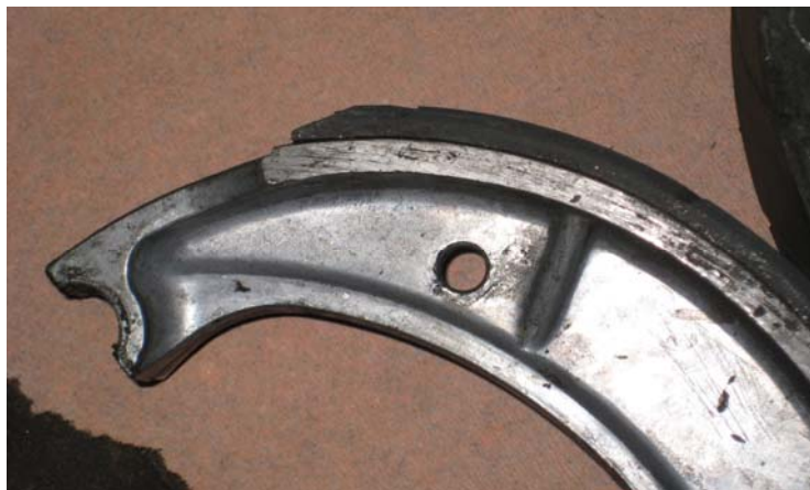
Ett bromsband som släpp ifrån aluminiumstommen
